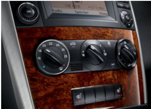
Klimaanlage mit Staubfilter und Umluftschalter.
